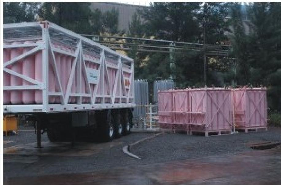
O Gás Natural Comprimido (GNC) é transportado em cilindros e entregue a clientes que não são atendidos pela rede de distribuição da Gasmig.
