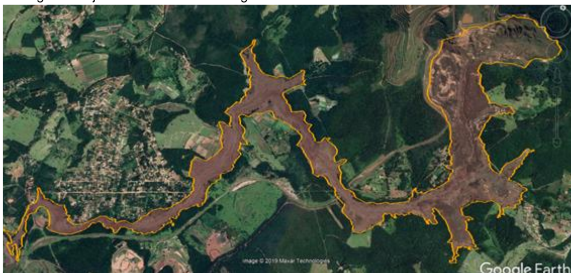
Figura 11 - Mancha formada pelo rejeito proveniente do rompimento da Barragem B1/Mina Córrego do Feijão sobre o terreno da região.
