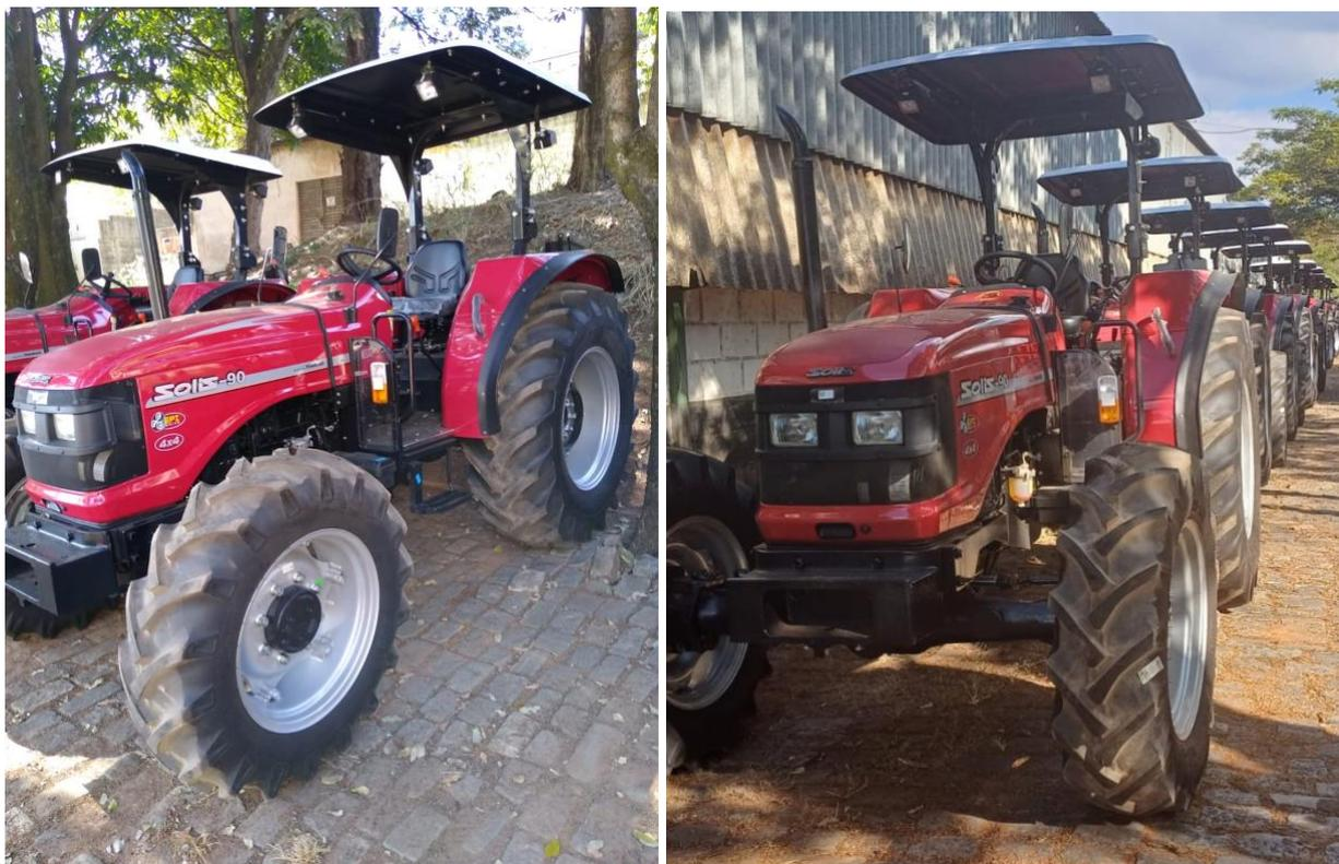
Foto: Trator Agrícola com potência motor de 90 cv
