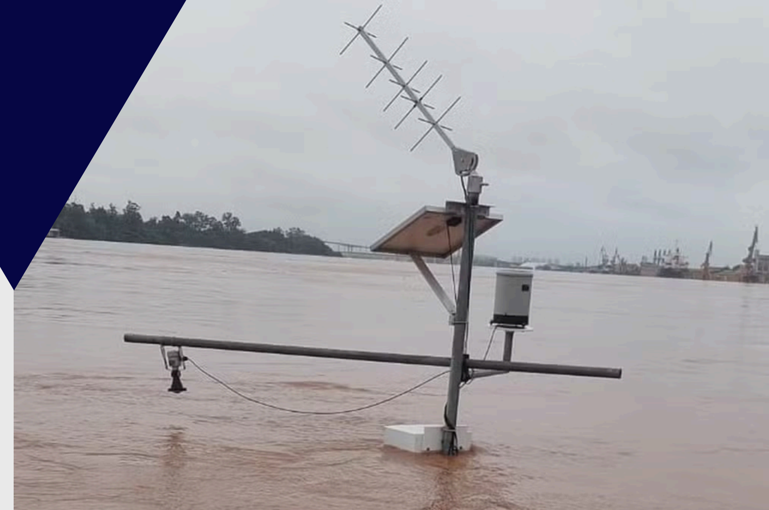
Estação de monitoramento com transmissão de dados em tempo real no Cais Mauá, em Porto Alegre — Foto: Arquivo pessoal
