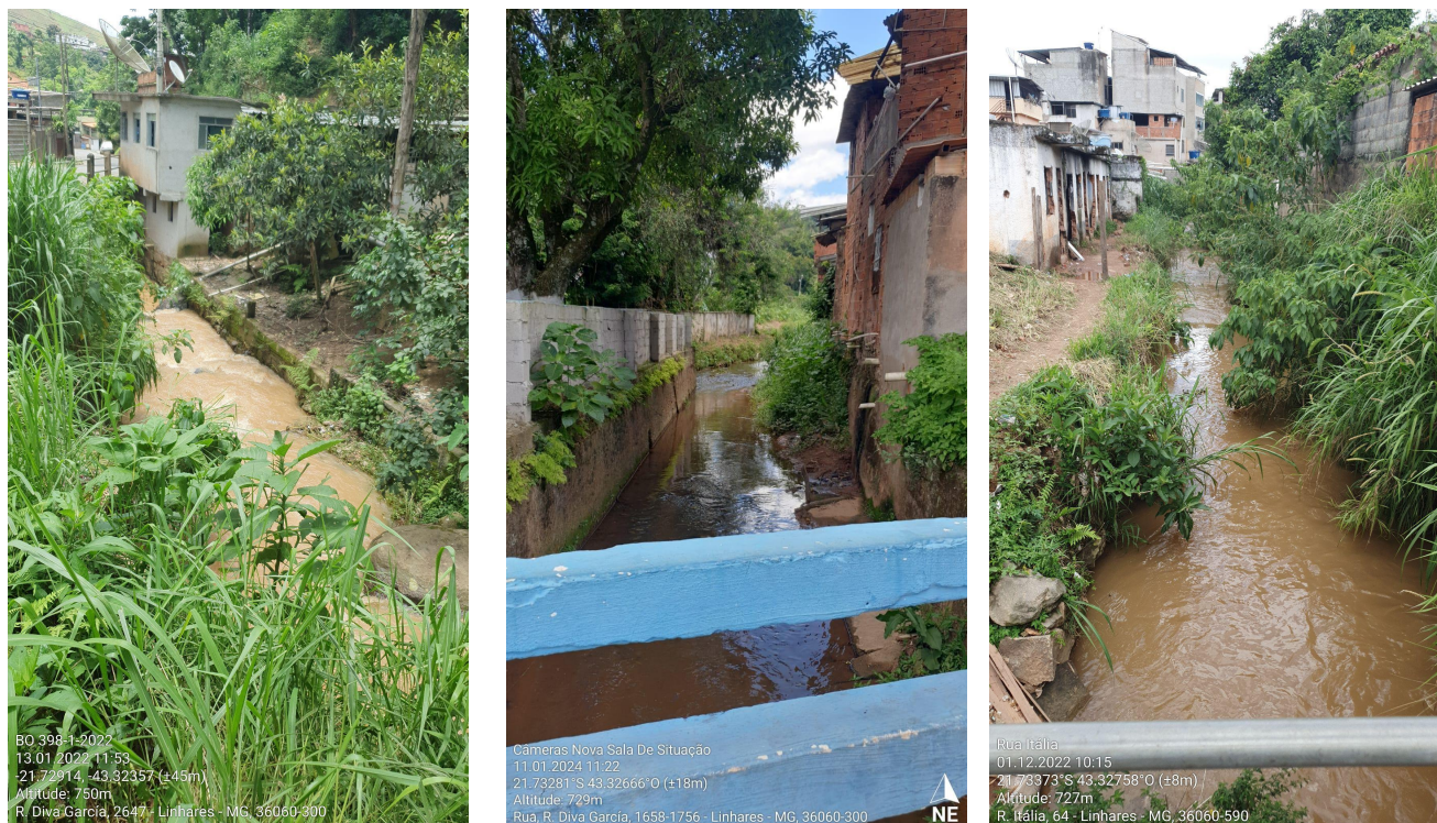
Figura 15 - Avaliação de campo para identificação da condição da calha do curso d'água, visando atribuir coeficientes importantes para os processos de modelagem hidrológica e hidráulica.
